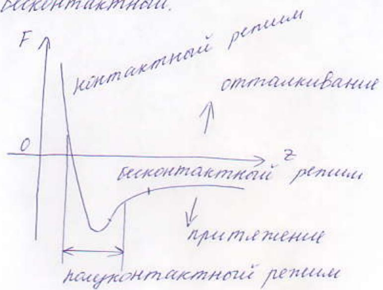
2 рисунок. Режимы работы атомно-шлифового микроскопа
